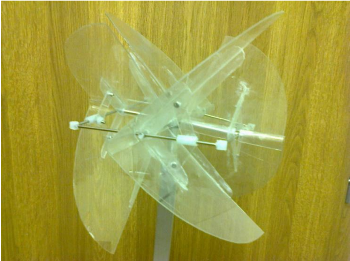
Rys. 4. Prototyp do badań doświadczalnych w tunelu aerodynamicznym.
