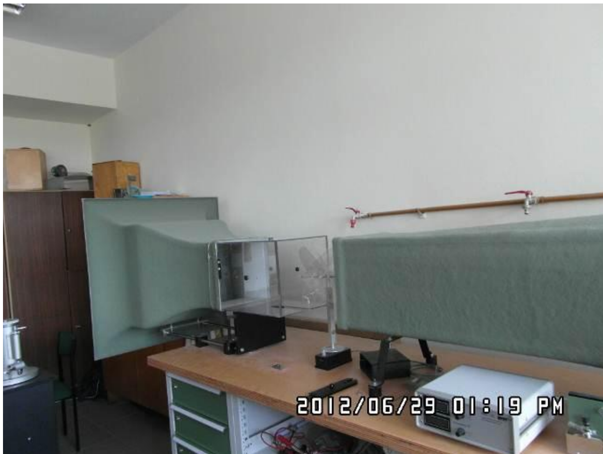
Rys. 3. Stanowisko do badań innowacyjnej turbiny wiatrowej w tunelu aerodynamicznym.
